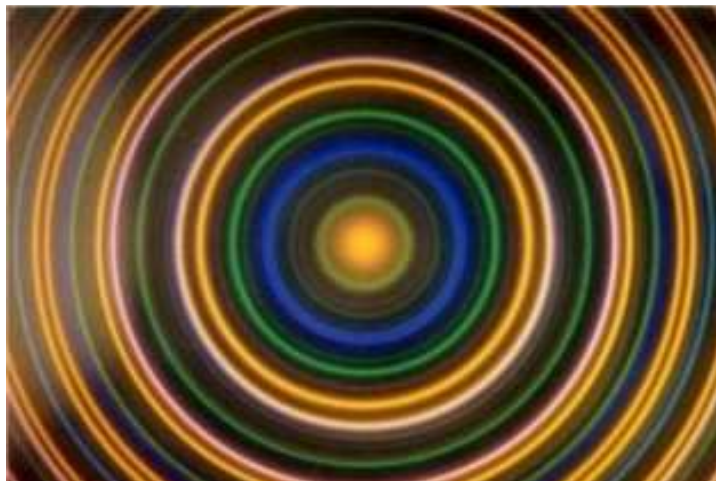
Anneaux d'égal inclinaison observés avec une lampe spectrale à vapeur de cadmium
