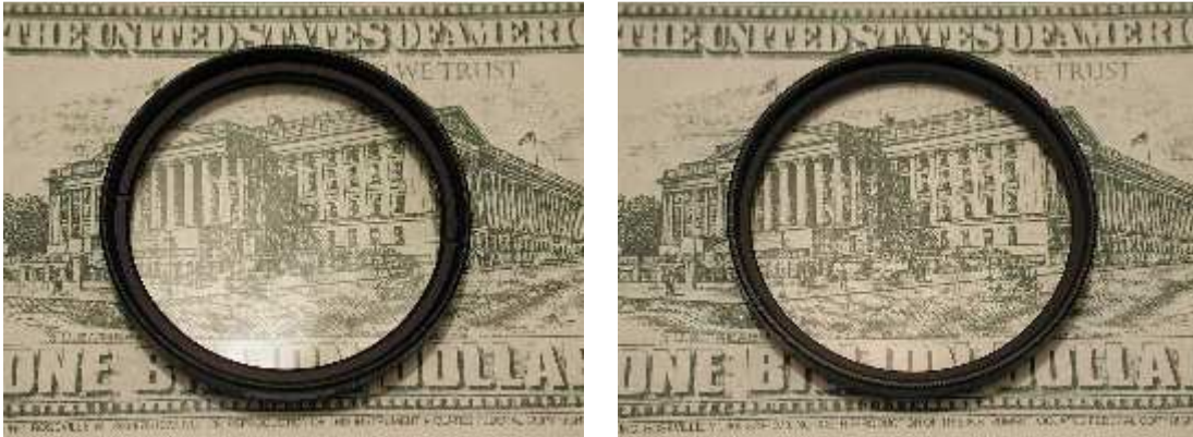
A gauche : un verre non traité présente un large reflet dans la partie inférieure gauche. A droite : un verre traité « multicouches ». La transmission s'est améliorée d'environ 3%.
