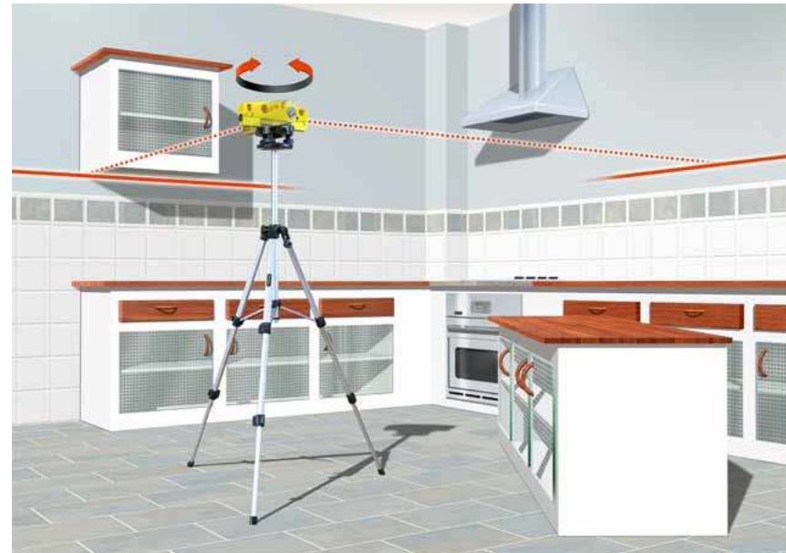
Repérage et traçage à l'aide de niveaux laser
