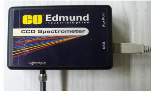
Spectromètre BRC112E - VIS
