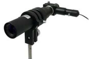
Relire le « Principe de la méthode par visée » exposé à la fin du §2.1- ; on dispose donc du faisceau de lumière parallèle à l'axe optique de la lentille à mesurer.
