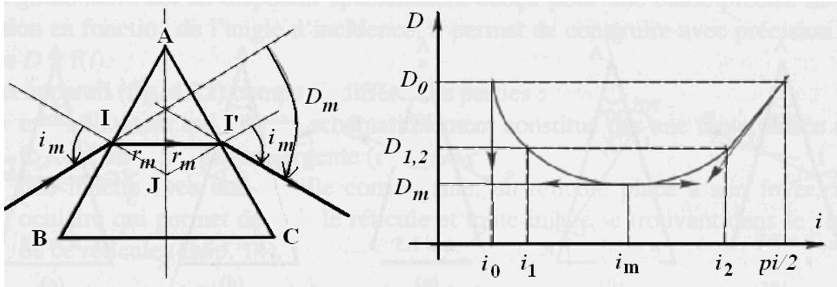
En raisonnant par « retour inverse » de la lumière en situation de minimum de déviation, on déduit que la figure doit être symétrique.
