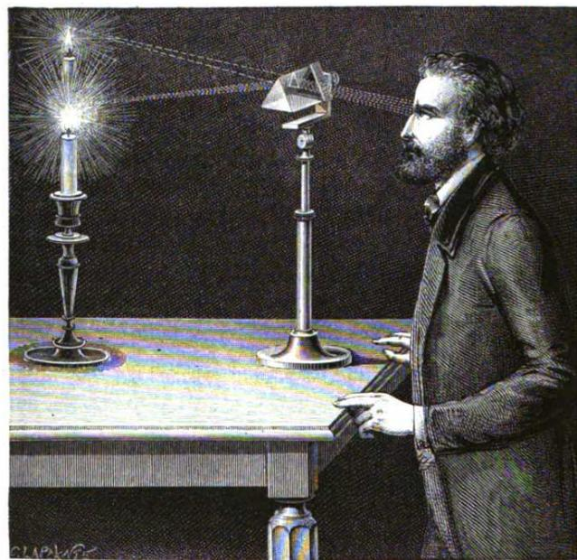
Vision à travers un prisme : déviation du faisceau
