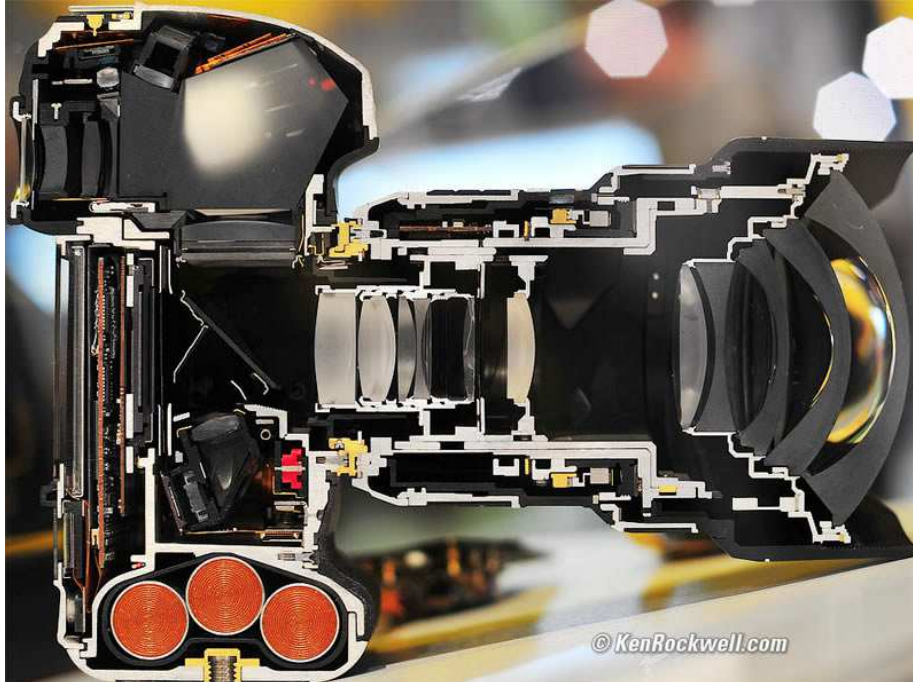
Coupe transversale d'un Nikon D3 AF-S Nikkor 12-24mm lens
