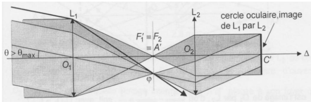
Des rayons trop inclinés sur l'axe sont stoppés (diaphragmés) par la monture de l'oculaire : le faisceau de rayons sortant de la lunette vers l'œil est limité par le diamètre de l'oculaire  $d$ . L'œil ne voit pas au-delà du « cercle oculaire image » ou « pupille de sortie », c'est-à-dire de l'image du périmètre de l'objectif  $L_1$  par l'oculaire  $L_2$ .
