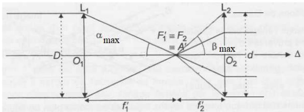
Le faisceau entrant dans la lunette est limité (diaphragmé) par la monture de l'objectif de diamètre  $D$  (on parle aussi de « pupille d'entrée »). L'angle maximal vérifie :  $\alpha_{\text{max}} = \arctan(D/2 f'_1) = \arctan(30/700) = 2.45^\circ$
