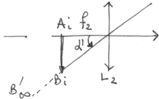
$\alpha'$  est le rayon angulaire apparent sous lequel on voit l'image virtuelle (à l'infini) avec la lunette en regardant dans l'oculaire. Cette image virtuelle finale observable à l'infini est l'un des avantages des systèmes afocaux puisque l'œil n'accommode pas et donc ne fatigue pas.
