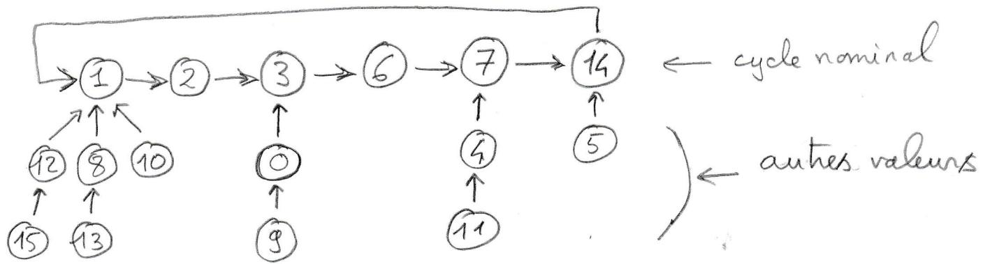
Ce circuit est stable : si jamais, à la mise sous tension ou à la suite d'une perturbation, il se trouve en dehors de son cycle nominal, il y rebrousse de lui-même (en 2 cycles d'horloge maximum dans le cas de ce circuit).
