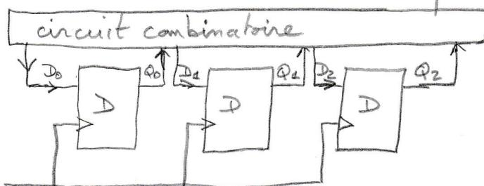
On veut réaliser ce circuit à l'aide de 3 bascules D dont les entrées  $D_0, D_1, D_2$  sont obtenues à partir de  $Q_0, Q_1, Q_2$  par un circuit de logique combinatoire
