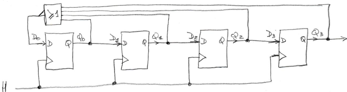
Ce circuit est un circuit de logique séquentielle car il utilise quatre bascules D. Il est synchrone car les 4 bascules sont activées par la même variable logique H.
