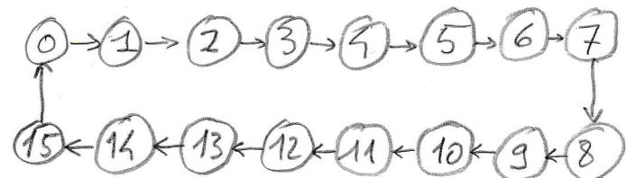
Ce circuit compte cycliquement de 0 à 15: à chaque front montant du signal d'horloge, la sortie passe de  $Q$  à  $Q+1$ , sauf quand  $Q=15$  où  $Q$  passe à 0.
