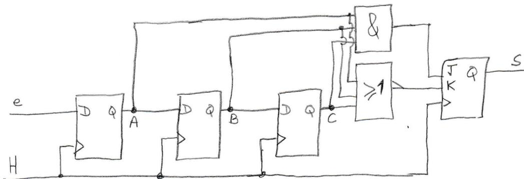
1) Ce circuit utilise 3 bascules D et 1 bascule JK, qui sont des composants élémentaires de logique séquentielle. C'est donc un circuit séquentiel.
