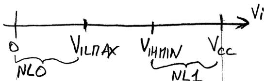
En sortie, un niveau 0 sera transmis par une tension comprise entre 0 et  $V_{OLMAX}$ , un niveau 1 par une tension comprise entre  $V_{OHMIN}$  et  $+V_{cc}$
