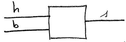
$s$  est à 1 dans l'intervalle de temps entre 2 passages de 0 à 1 de  $h$  et  $b$ .
