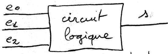
De tels circuits ont un comportement réflexe : ce qu'il y a sur les entrées détermine les sorties
