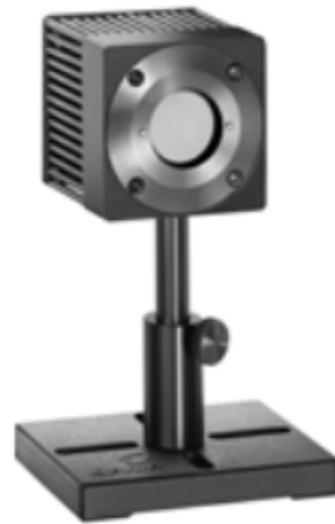
Mesureur de puissance continue pour laser industriel 40 mW-150 W sur bande IR 0.19-20  $\mu\text{m}$  (modèle : Ophyr 50A-BB-26)
