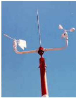
Mesure de vitesse du vent (direction et valeur)
