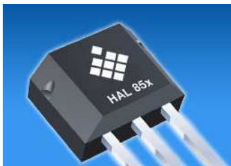
Capteur magnétique de présence de boucle de ceinture de sécurité auto (effet Hall)
