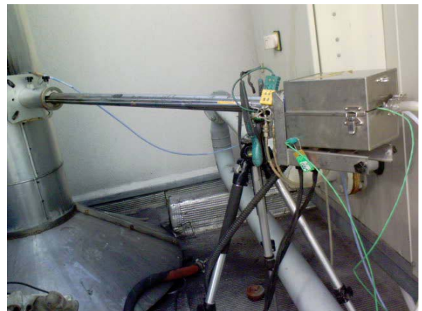
Canne de prélèvement avec boîtier du porte-filtre
